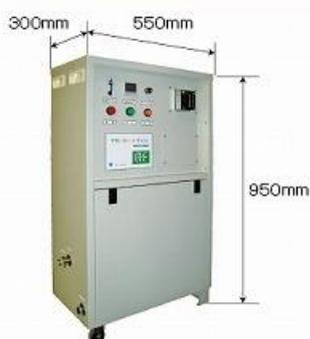
グローヒートファンは、水を沸騰させて発生した水蒸気をさらに高温に加熱し、過熱水蒸気と加熱空気を混合して送風機で送り出す暖房機です。水と電気を使用する園芸ビニールハウス用補助暖房機として、従来のハウス暖房機の重油・灯油等の燃料費削減に繋がります。コンパクトで設置や移動が容易です。
